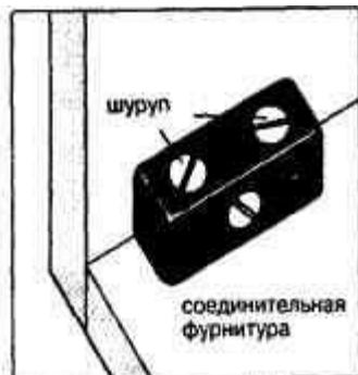
Рис. 11. Соединительная фурнитура: надежная даже для разборных конструкций.
