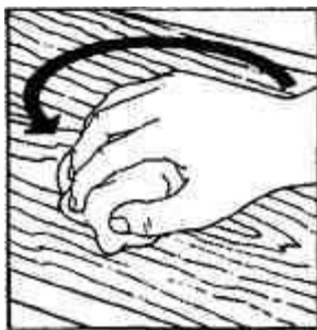
Рис. 61. Пасту для заполнения пор наносите кругообразными движениями, распределяя ее равномерно.
