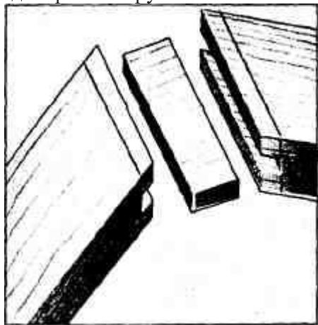
Рис. 33. Производство гребней требует много времени, но они надежны: гребни клеиваются в бороздки, которые пропиливаются по линии скоса.
